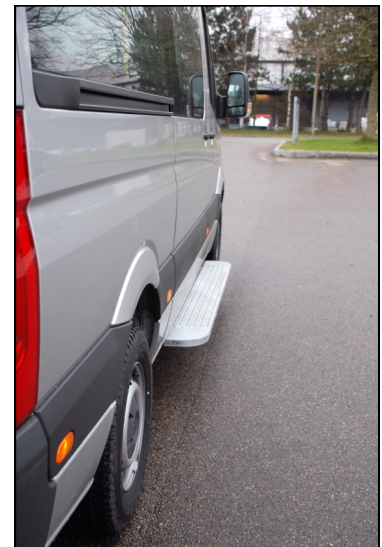
Trin ved skydedør og fordør
