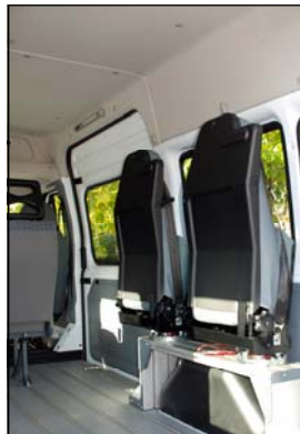
Nedsænkede hjulkasser og Jany 862-stole monteret på hjulkassebro
